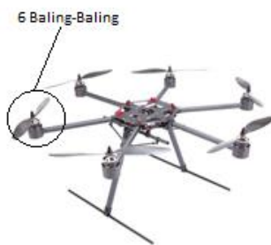
Gambar 4. Rotary wing UAV dengan 6 baling-baling [9]
