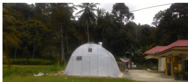
Gambar 5. Rumah pengering kerupuk ubi tipe solar tunner
