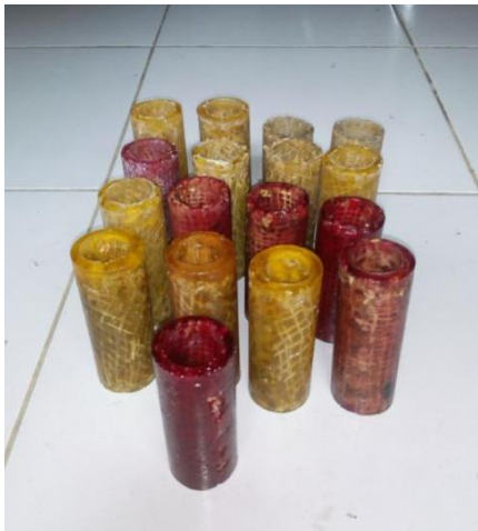
Gambar 4. Spesimen pengujian kekuatan lentur
