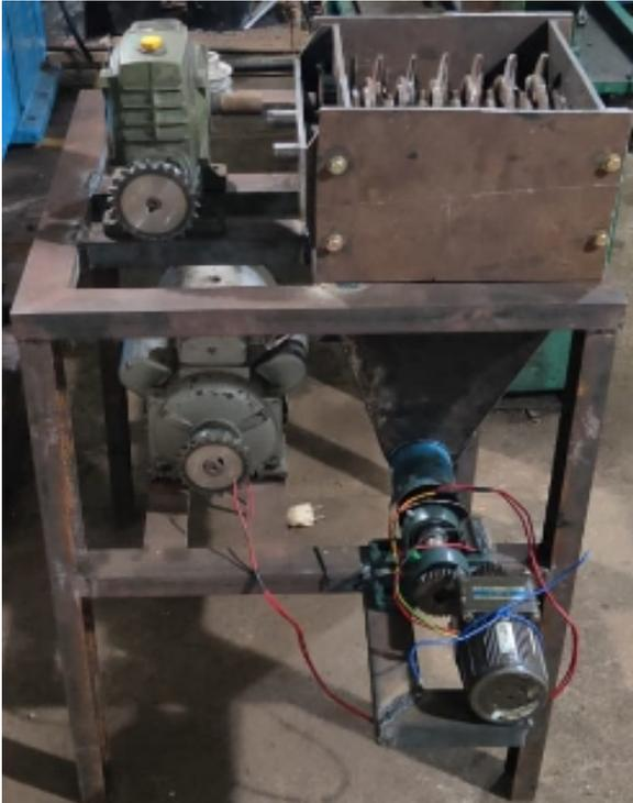
Gambar 6. Mesin pencacah dan injeksi plastik
