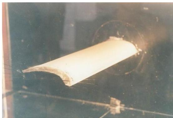
Gambar 3. Model airfoil sayap kumbang kelapa terpasang di terowong angin
