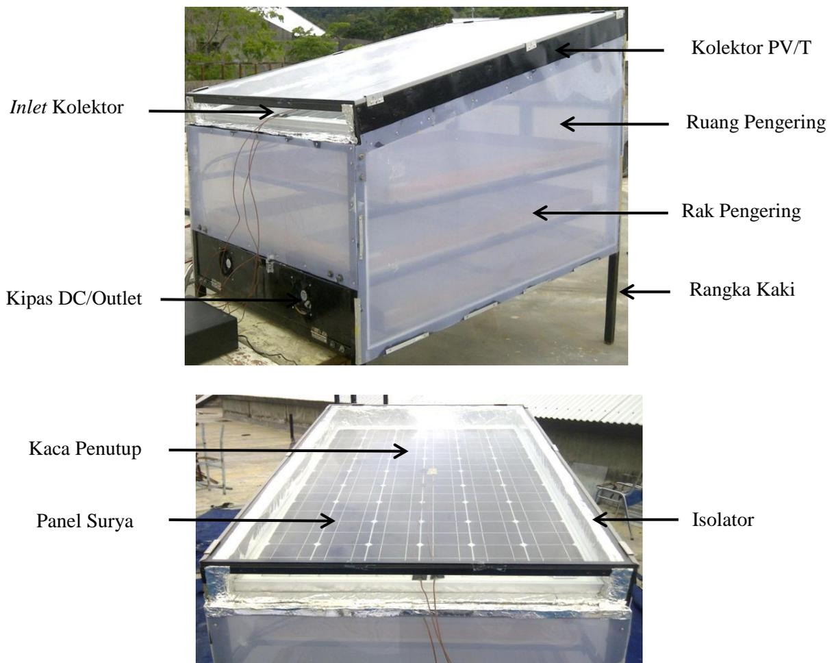
Gambar 2. Perangkat pengering surya PV/T tipe rak
