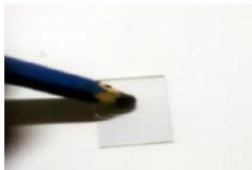
Gambar 4. Pensil 2B Digosokkan pada Sisi Kaca Konduktif
