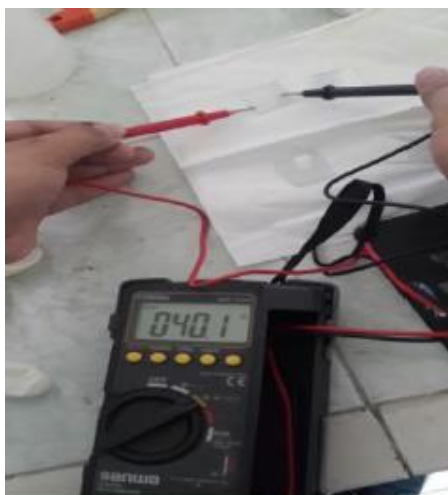
Gambar 1. Pengecekan Sisi konduktif dari Kaca FTO
