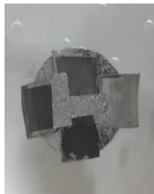
Gambar 5. Benda Kerja Telah Dilapisi AuPd
