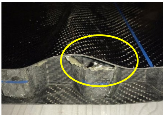
Gambar 10. Terlepasnya ikatan antara inti dan kulit dari spesimen panel honeycomb sandwich komposit serat karbon
