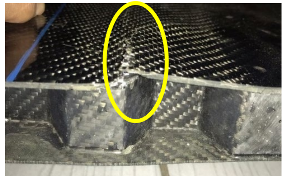
Gambar 11. Fenomena patah getas pada kulit bagian atas dari spesimen panel honeycomb sandwich komposit serat karbon
