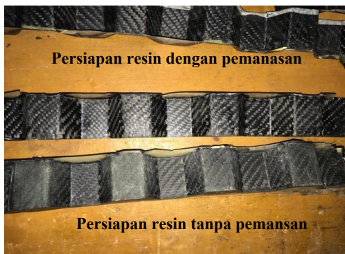
Gambar 6. Perbedaan tampak luar lembaran bergelombang yang dibuat dengan dua metoda
