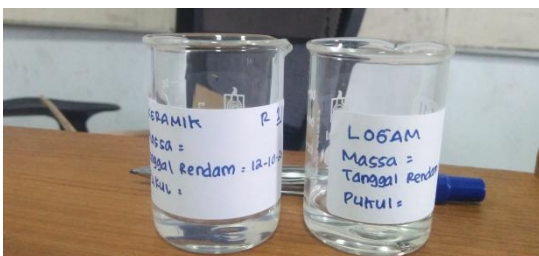
Gambar 1. Spesimen dimasukkan ke dalam larutan saliva buatan.
