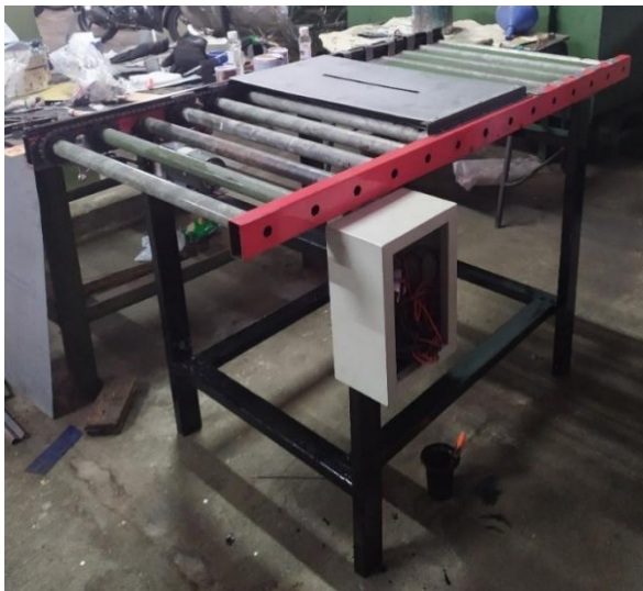
Gambar 6. Rangka Dan Roller Conveyor Mesin Pemanas Akrilik
