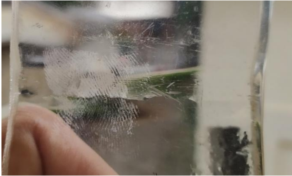
Gambar 14. Hasil Bending Spesimen Temperatur Akrilik 140 °C
