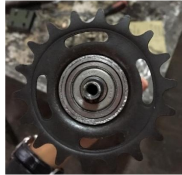
Gambar 5. Sprocket Pada Roller Conveyor
